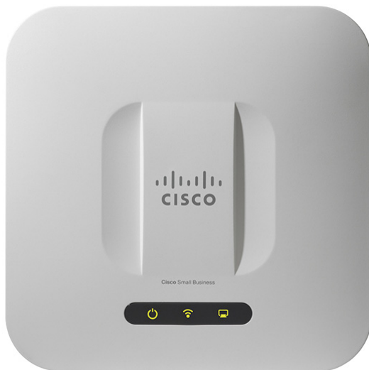
图 2. 支持 PoE 的 Cisco WAP551/WAP561 Wireless-N 接入点的前面板
