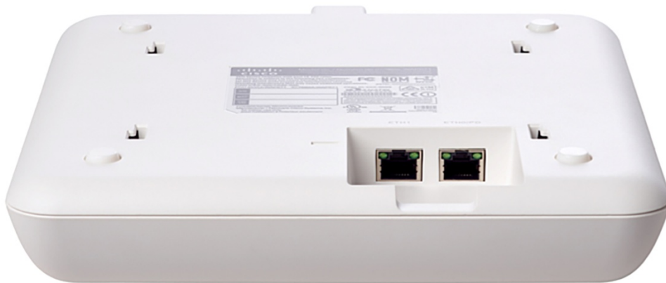
Abbildung 3. Rückseite des WAP571 Wireless-AC/N Premium Dual Radio Access Point
