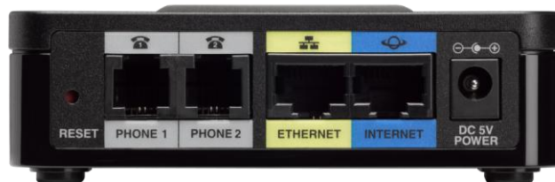
Figura 2. Puertos del ATA con router Cisco SPA122
