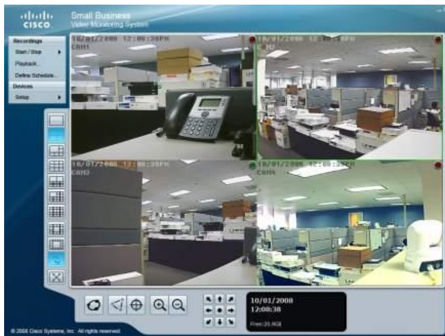
Figura 1. Sistema de supervisión por video Cisco Small Business para 16 cámaras
