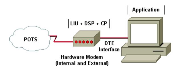
في مودم الأجهزة، يقوم المودم بمعالجة وظائف LIU و DSP و CP. تاريخيا، كانت أجهزة مودم الأجهزة هي الأفضل من حيث الأداء ومن حيث النوع الأكثر موثوقية. يمكن أن تكون أجهزة مودم الأجهزة خارجية أو داخلية. باستخدام أجهزة مودم خارجية، يعمل كابل طبيعي (مثل الواجهة التسلسلية RS-232) على توصيل الكمبيوتر للمودم. في أجهزة المودم الداخلية للأجهزة، يقوم الناقل الداخلي للكمبيوتر بمعالجة هذه الدالة.
