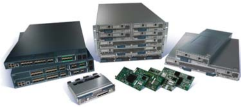
圖 1：思科整合運算系統包括光纖互連、光纖延展器、刀鋒伺服器機箱、刀鋒伺服器、網路卡、延伸記憶體技術(不包含在以上圖片中)
