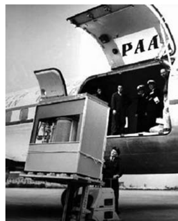
Так выглядел жесткий диск образца 1956 года. Он весил одну тонну и мог хранить 5 мегабайт информации.
