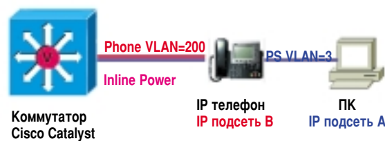
Рисунок 10. Один из способов подключения IP телефона к коммутатору локальной сети
