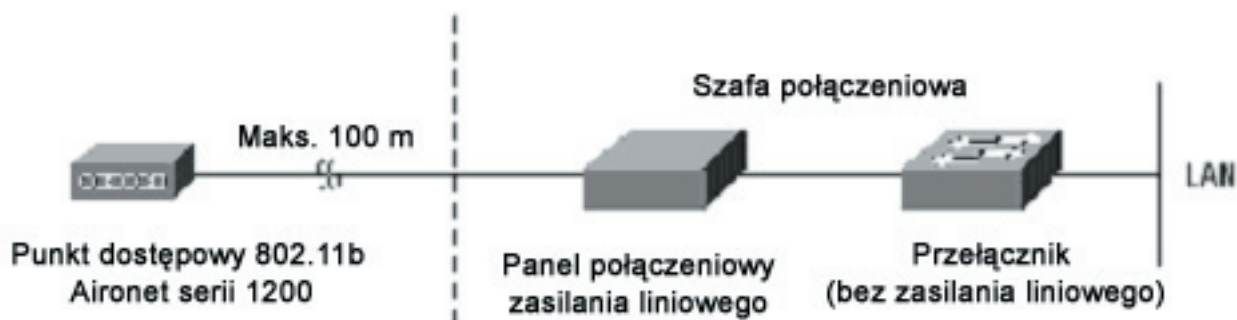
Rysunek 12. W przypadku skonfigurowania urządzenia z radiem 802.11b lub 802.11g, zasilanie przez Ethernet może być zapewnione przez Cisco Catalyst Inline Power Patch Panel.
