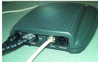
Unidad de Acceso, este es el equipo que cada usuario tiene, en este caso está conectado un solo PC, pero también puede conectarse un Switch o HUB.
