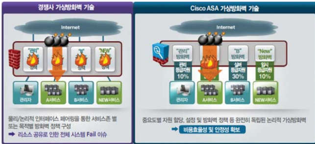
〈그림 1-5 Cisco 자원 독립적 가상방화벽 vs 경쟁사 정책기반 가상 방화벽 기술 비교〉
