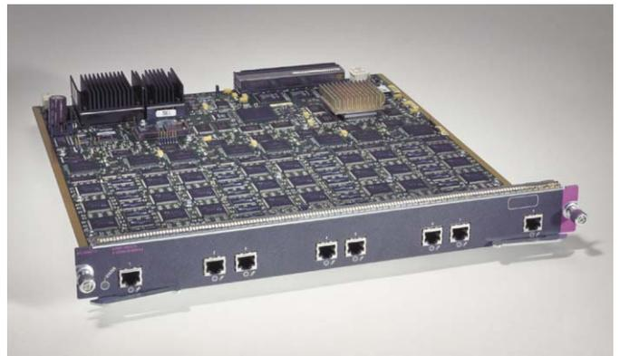
Voice T1 and Services 모듈은 PSTN이나 PBX에 연결되는 8개의 T1 포트(192 채널 또는 DS0 음성 트렁크)가 있습니다. PSTN나 기존 PBX에 대한 게이트웨이로서, 이 모듈은 IP 네트워크에 패킷을 전달하거나 IP 네트워크로부터 패킷을 받기 위한 음성 패킷화 서비스를 제공합니다. 이 모듈은 ISDN PRI(Primary Rate Interface)와 CAS(Channel Associated Signaling) 같은 음성 트렁크 프로토콜을 지원합니다. Voice T1 and Services 모듈을 설치하면, 한 대의 Catalyst 6500 스위치로도 구내 전체를 충분히 지원할 수 있는 음성 트렁킹 기능을 제공합니다.
