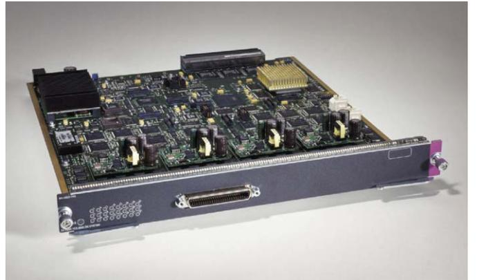
Catalyst 6500 FXS 아날로그 인터페이스 모듈은 아날로그 전화기, 회의실 스피커 폰, 팩스를 연결하는 24개의 FXS(foreign exchange station) 포트가 있습니다. 이 FXS 모듈로 기존 아날로그 장치를 IP 네트워크에 연결하여 톨 바이패스 애플리케이션을 위한 IP 네트워크 인프라를 활용하고, IP 폰과 H323 엔드 스테이션과 같은 장치와 커뮤니케이션할 수 있습니다.
