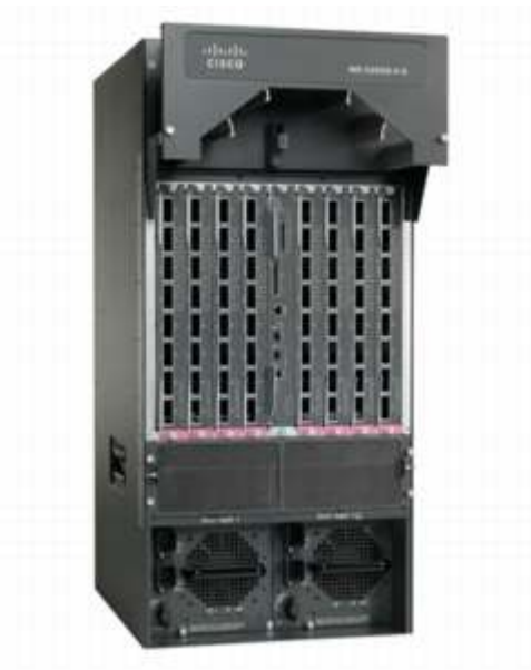
그림 1. Cisco Catalyst 6509-V-E 새시
