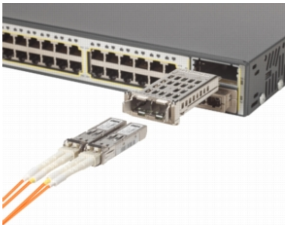
그림 2. 10 기가비트 이더넷 X2 인터페이스를 두 개의 기가비트 이더넷 SFP 인터페이스로 변환하는 Cisco TwinGig 컨버터 모듈
