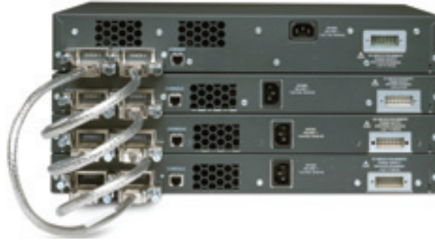
그림 2 Cisco StackWise Technology Resilient Cabling
