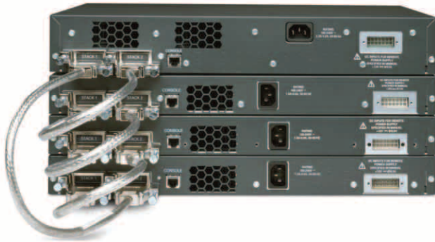
그림 2 Cisco StackWise Technology Resilient Cabling
