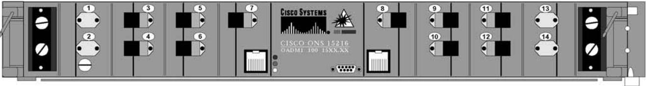
그림 4: Cisco 15216 100-GHz OADM2의 전면 패널 포트 레이아웃
