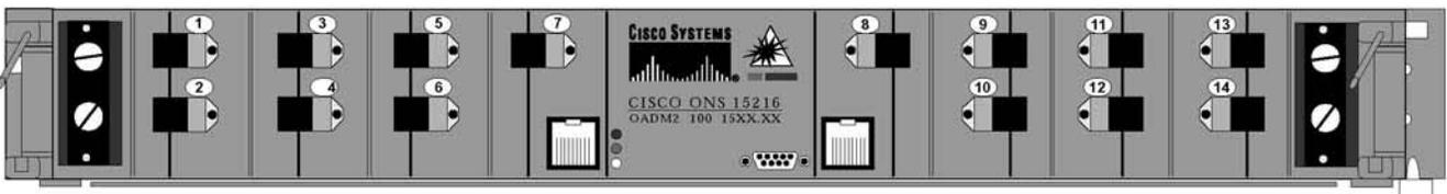
그림 5: Cisco 15216 100-GHz OADM4의 전면 패널 포트 레이아웃
