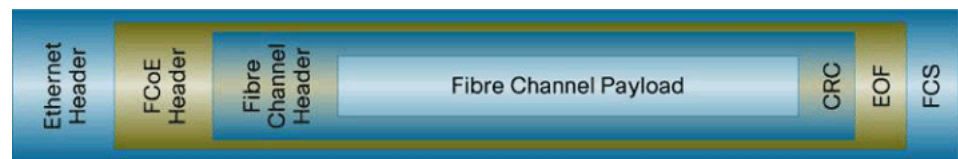
図 2 ファイバチャネル フレームのイーサネット パケットへのカプセル化
