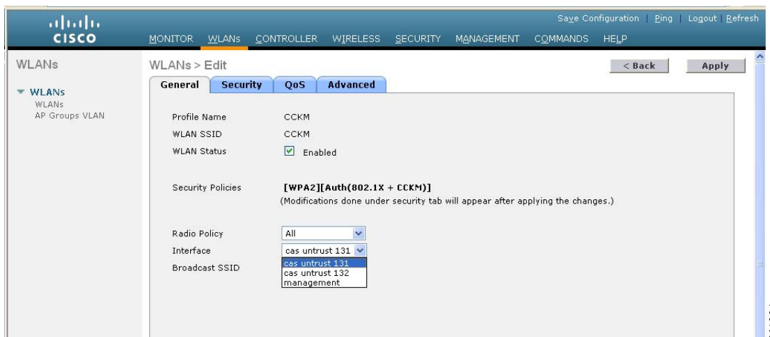
図 5-40 WLAN : 動的インターフェイスの割り当て
