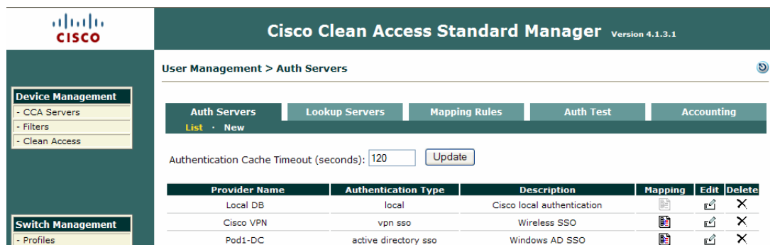
図 5-69 無線 SSO 用の VPN SSO 認証サーバ
