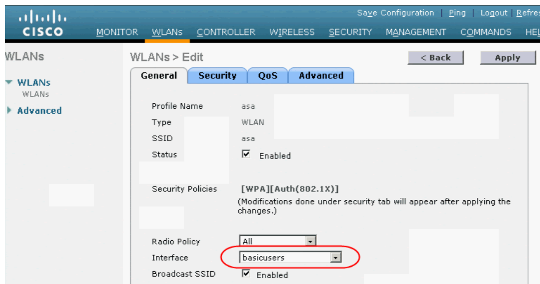
図 6-10 WLC の WLAN の設定
