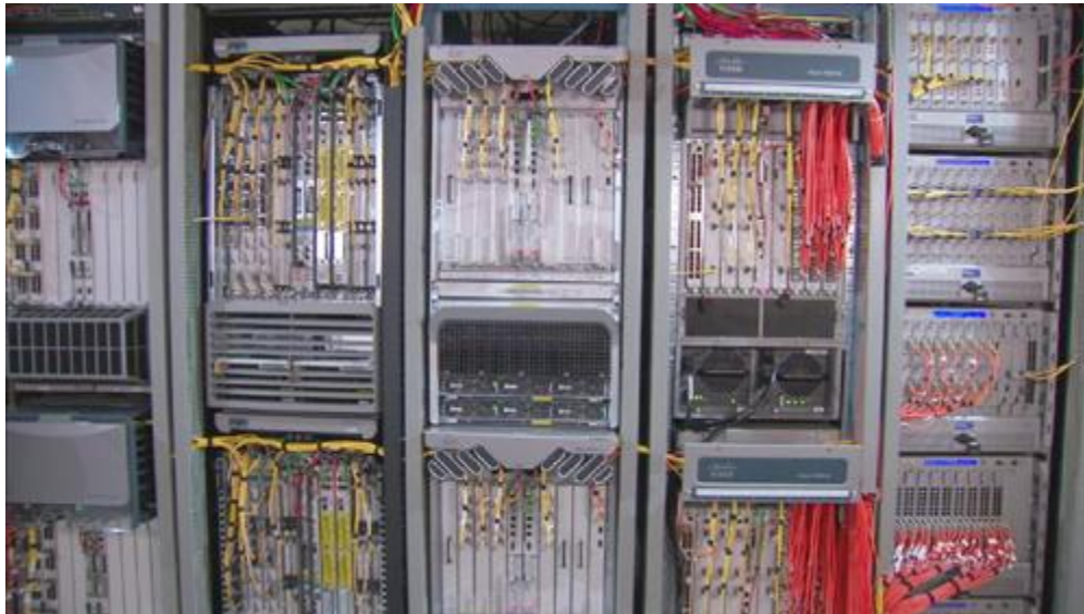
テストベッド (左から右へ) Nexus 7000、CRS-1、ASR 9010、7609-S、および Spirent の TestCenters
