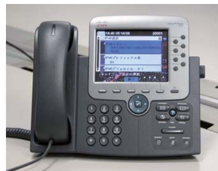
IPv6スタックで動いているIP Phone。設定情報はCUCM側で管理されており、それが自動的にダウンロードされている。
