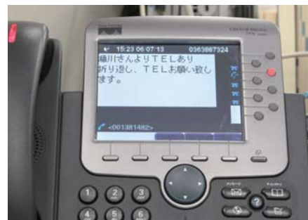
今回導入されたCisco Unified IP Phone 7970G (上) IPフォン本体にも簡単なテキストメッセージが残せる(下)
