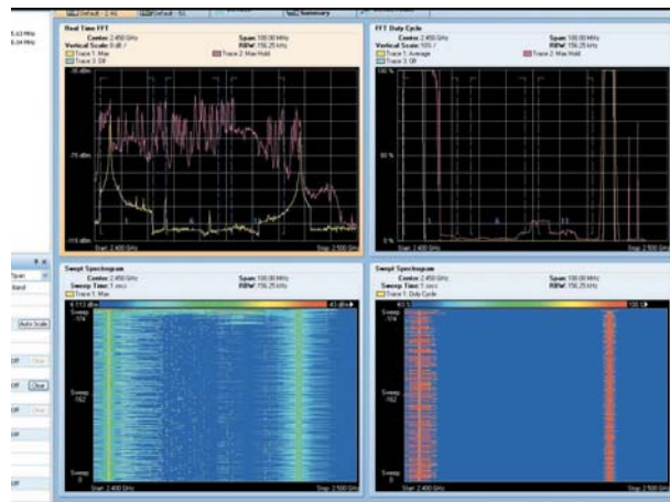
図 4 狭帯域電波妨害装置のスペクトルキャプチャの例
