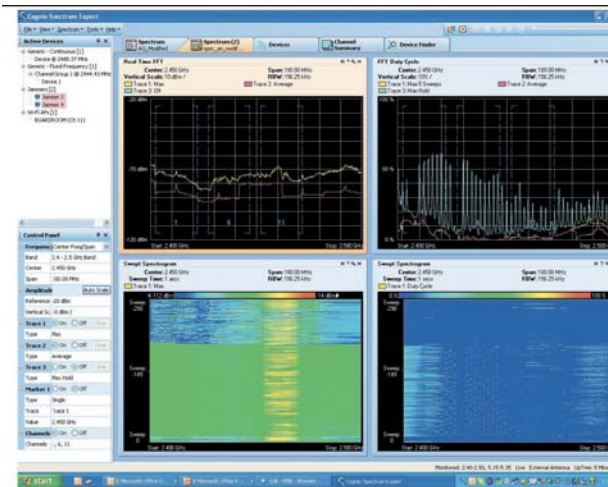
図 5 広帯域電波妨害装置のスペクトルキャプチャの例
