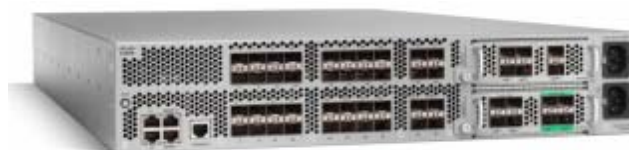
図 2 Cisco Nexus 5000 シリーズの Cisco Nexus 5020 は、10 ギガビット イーサネットの固定ポート 40 個 (ポート 1 ~ 16 はギガビット イーサネットにも対応)、FCoE、および 2 つの拡張モジュール スロットを備えています
