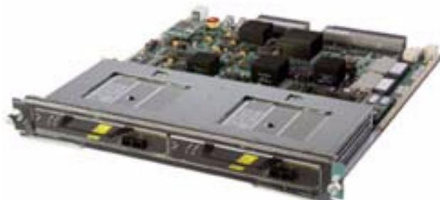
図 1 Cisco 7600 シリーズ / Catalyst 6500 シリーズ 拡張 FlexWAN モジュール
