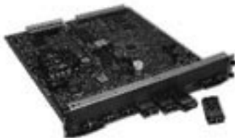
図3：最新の2ポートのGBICアップリンクはQoS機能を提供
