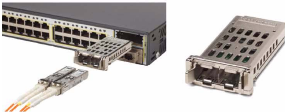
図 2 10 ギガビット イーサネット X2 インターフェイスを 2 つのギガビット イーサネット SFP インターフェイスに変換する Cisco TwinGig アダプタ
