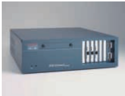
Cisco Secure PIX 520 一般企業向き スループット:370Mbps/セッション数:250,000/CPU:350MHz インタフェース:最大6つ
