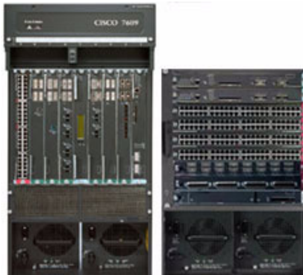
図 2 単一プラットフォームでの LAN、WAN、および MAN の統合 : Cisco 7609、Cisco Catalyst 6509
