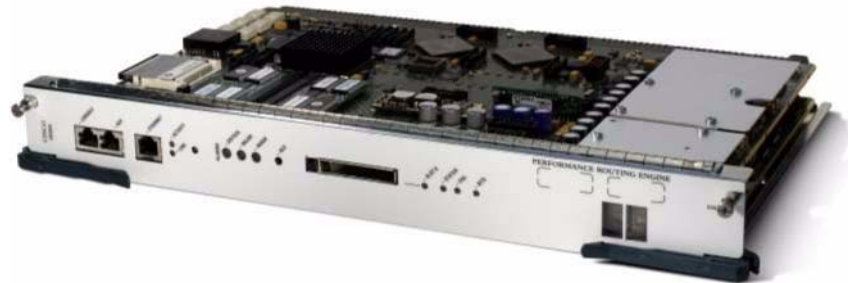
図 1 Cisco 10000 シリーズ Performance Routing Engine 3 (PRE-3)
