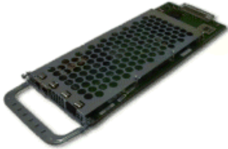
図4: Cisco AS5350 2、4、および8ポート終端DFC
