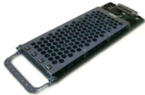
図5: Cisco AS5350 60および108ユニバーサルポートカード
