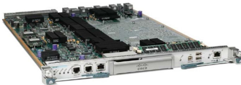
Figura 3. Modulo supervisor Nexus 7000 di Cisco
