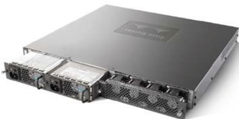
Figure 2. Vue arrière du commutateur Cisco Catalyst 4948 avec ses deux alimentations redondantes et son module de ventilation extractible
