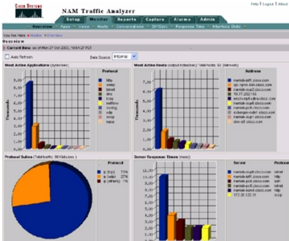
Figure 2 : Surveillance du trafic LAN et WAN grâce à l'analyseur de trafic NAM incorporé
