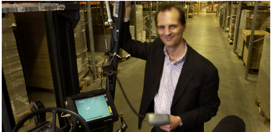
I trucken er der installeret en industri-pc med touch-screen. På denne måde kan truckføreren nemt holde styr på varelageret.
