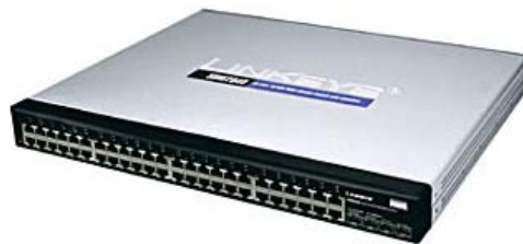
Abbildung 1. Cisco SRW2048 Switch mit 48 Gigabit-Ports und WebView
