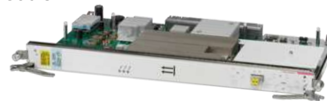
CRS-3 1 Port 100GigE CFP Interface Module
