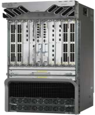
Edge Router ASR9000
