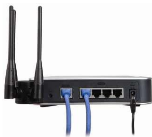
图 2 Cisco WRVS4400N Wireless-N 千兆安全路由器的端口连接
