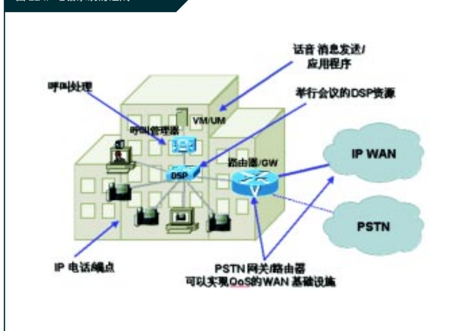
图 12 IP 电话系统的组成
