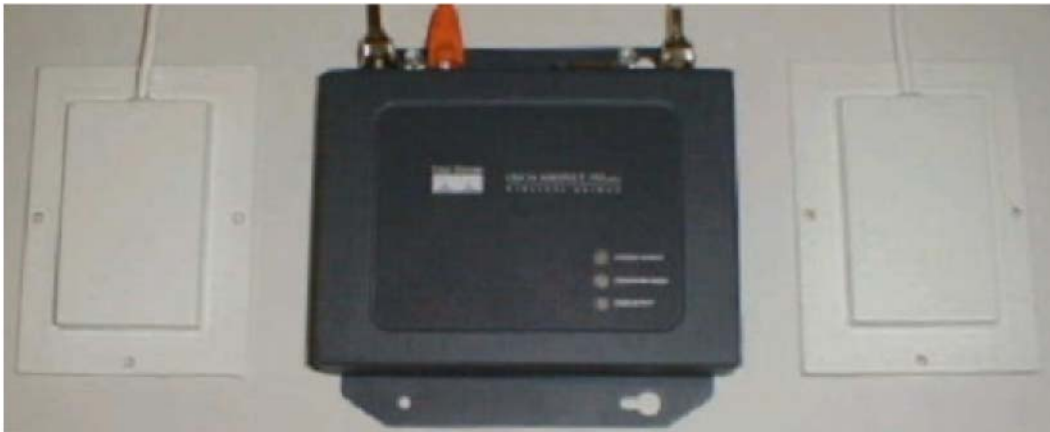
Figure 4 思科Aironet 350系列无线设备连接2块6.0 dBi板状天线做分集
