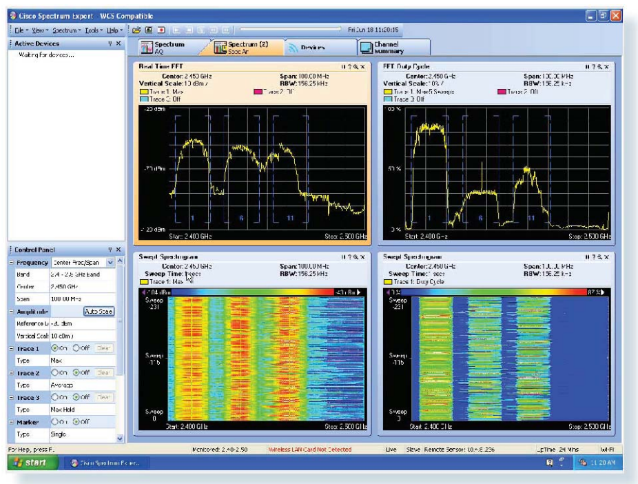
图 47. 将 CleanAir 接入点用作远程传感器的 2.4 GHz 频谱
