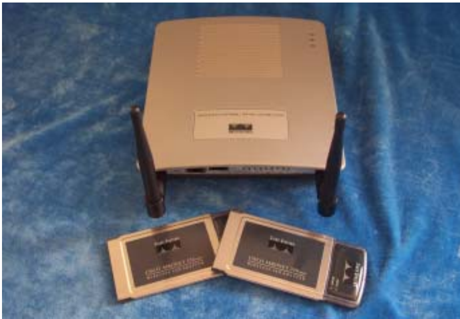
图一 Cisco AIR-AP 1200 型 AP 与 350 系列 PCMCIA 无线局域网卡
