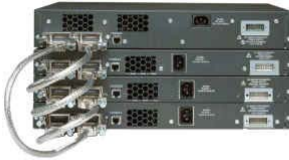
图 2 思科 StackWise 技术富有弹性的布线方式
