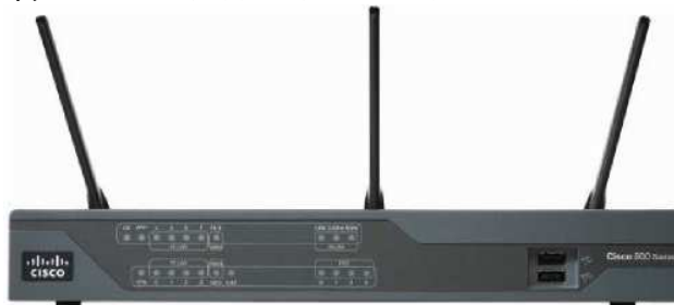
图 1. Cisco 890 系列集成服务路由器，集成 802.11 n 接入点
