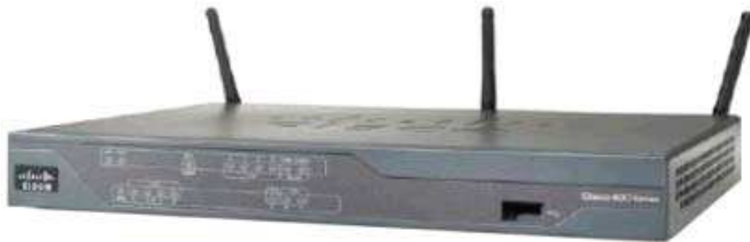
图 1 配有集成 802.11n 接入点的 Cisco 881 集成多业务路由器。
