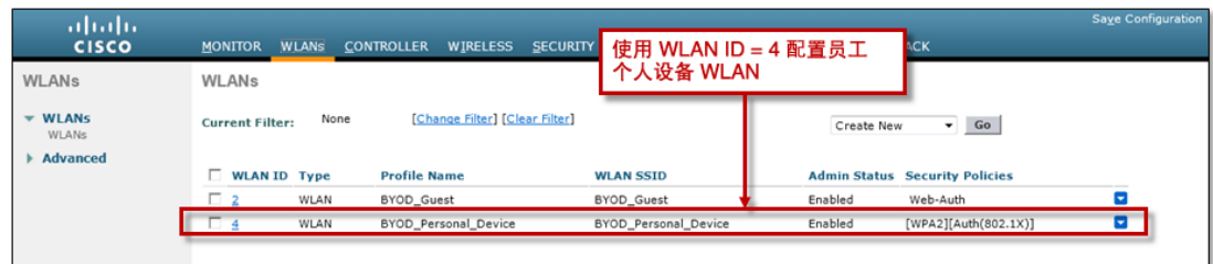
图 12-16 显示员工个人设备 WLAN 和 SSID 的无线控制器 WLAN ID 示例
