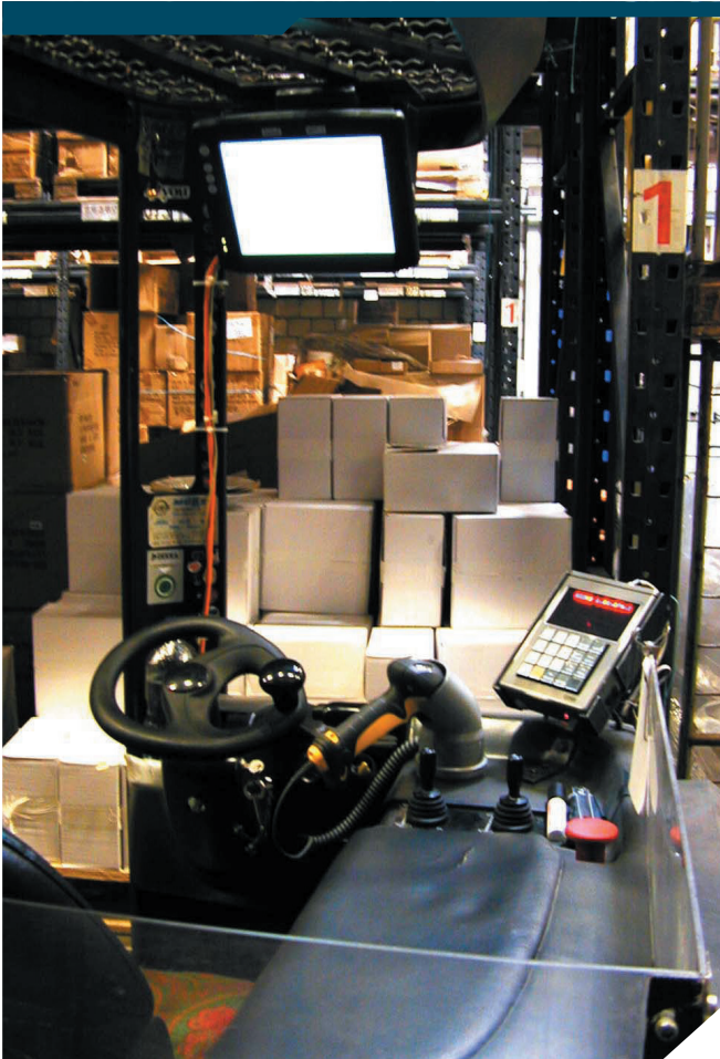
Blick in einen Stapler mit dem alten, abzulösenden System (unten rechts) und dem neuen D-Log Term (mit eingebauter Cisco W-Lan Karte) (unter dem Dach montiert) und Scanner
