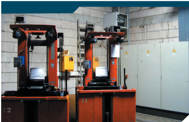
Blick auf zwei Kommissioniergeräte mit noch eingepackten Datenfunkterminals (D-Log) (mit eingebauter Cisco W-Lan Karte) an der Batterieladestation. Der schwarze Kasten auf dem Dach gehört zum alten Infrarot System das abgelöst wird.
