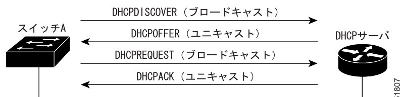
図 4-1 DHCP クライアントとサーバのメッセージ交換
