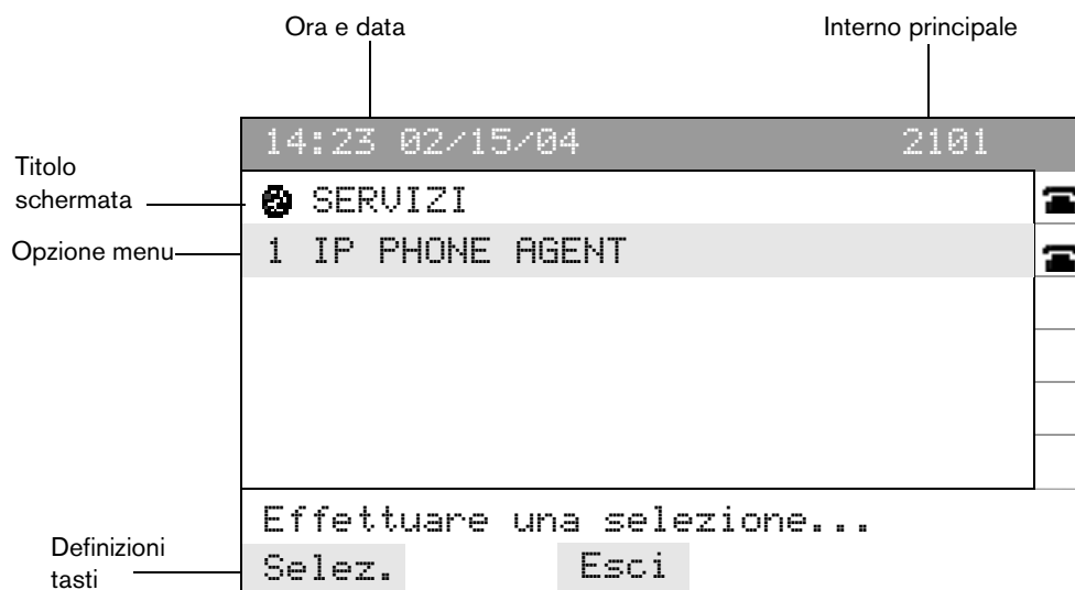
Figura 1. Menu iniziale di IP Phone Agent. È possibile che il menu in uso sia diverso.
