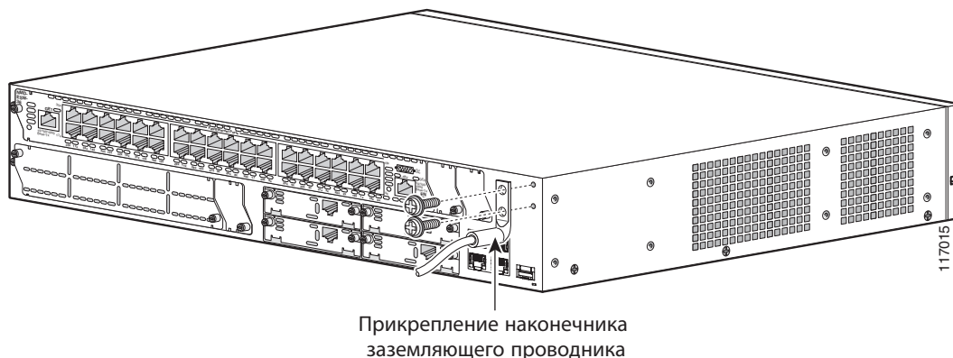
Рис. 10 Заземление шасси маршрутизатора Cisco 3825, совместимое с NEBS
